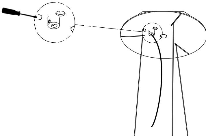
5. ADJUST THE LENGTH OF THE WIRE AND TIGHTEN PLASTIC SCREW / AJUSTER LA LONGUEUR DU FIL ELECTRIQUE ET SERRER LA VIS DE PLASTIQUE
