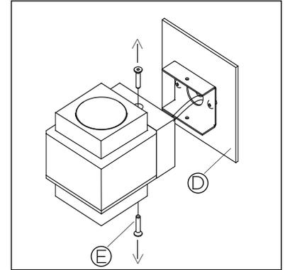
**3 • RELEASE CANOPY ASSEMBLY(D) FROM LUMINAIRE BY UNSCREWING CANOPY SCREWS(E).**
