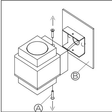
**1 • RELEASE CANOPY ASSEMBLY(B) FROM LUMINAIRE BY UNSCREWING CANOPY SCREWS(A).**
