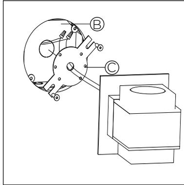
**2 • INSTALL UNIVERSAL MOUNTING BRACKET (C) TO JUNCTION BOX (B). FASTENERS NOT SUPPLIED.**
