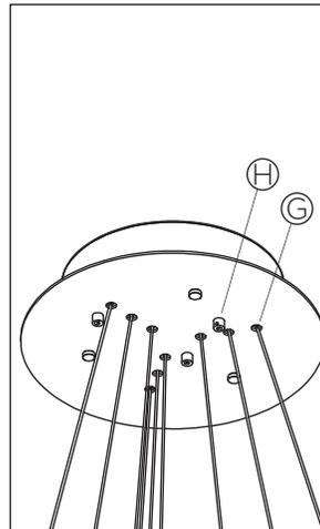
**6 • ADJUST LIGHT HEIGHT TO DESIRE USING THE GRIPPERS (G). ADJUST ELECTRICAL CABLE LENGTH TO DESIRED LENGTH USING THE STRAIN RELIEF (H).**
