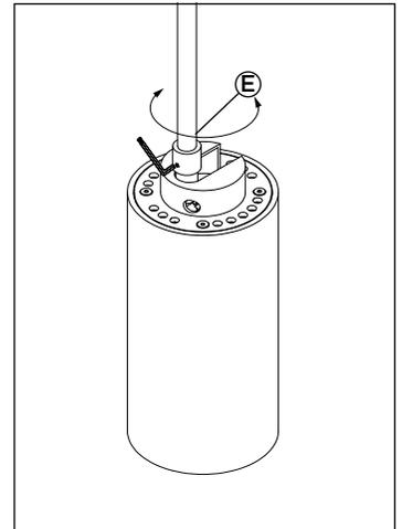
**4 • ADJUST THE DIRECTION OF THE LUMINAIRE USING AN ALLEN KEY (NOT PROVIDED). MAKE SURE THAT THE LAMP DOESN'T GET OUT OF THE SOCKET (E) WHILE IT'S TURNING.**
