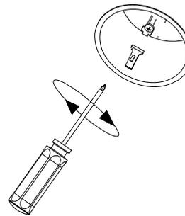
6- Insérer l'ampoule dans la douille. Clipper la lampe à l'intérieur de la finition. Maintenez une pression sur les ressorts plats et insérer délicatement la finition dans le boîtier. / Insert the lamp into the lampholder. Install the lamp in the trim. Press on the flat spring and insert gently trim into housing.
