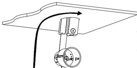
4- Insérer le boîtier dans l'ouverture de plafond jusqu'à ce que le rebord touche le plafond / Insert the housing into the ceiling opening until the rim touches the ceiling.
