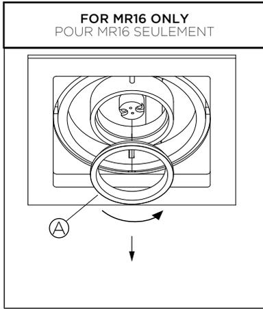
**1 • TURN-OFF LUMINAIRE BEFORE SERVICING AND UNSCREW LAMP HOLDER RING(A).**
