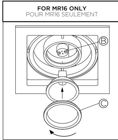
**2 • INSERT THE LAMP INTO THE SOCKET(B) AND SCREW BACK RING(C)**
