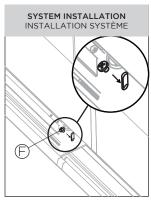
TIGHTEN JOINER SCREWS (F) FOR ADDED SUPPORT AND ALIGNMENT.
