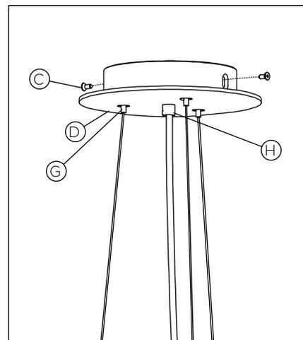
**6 • PLACE BACK THE CANOPY PLATE (D) AND TIGHTEN PROVIDED SCREWS (C) ON THE SIDE TO SECURE CANOPY. ADJUST THE LUMINAIRE'S HEIGHT AS DESIRED USING THE GRIPPERS (G). ADJUST ELECTRICAL CABLE LENGTH USING THE STRAIN RELIEF (H).**
